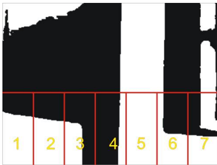
Figura 7: Parte que se analizará del Umbral, para después sacar las sumatorias y su posterior decisión.
