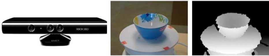
Figura 5.5: Sensor RGBD marca Kinect (Zhang, 2012). Esta clase de sensor genera simultáneamente imágenes de color y profundidad, que se utilizan junto con técnicas de procesamiento de imágenes para inferir información de alto nivel acerca del entorno, tal como clasificar objetos, seguir personas y detectar eventos (Han, Shao, Xu & Shotton, 2013).
