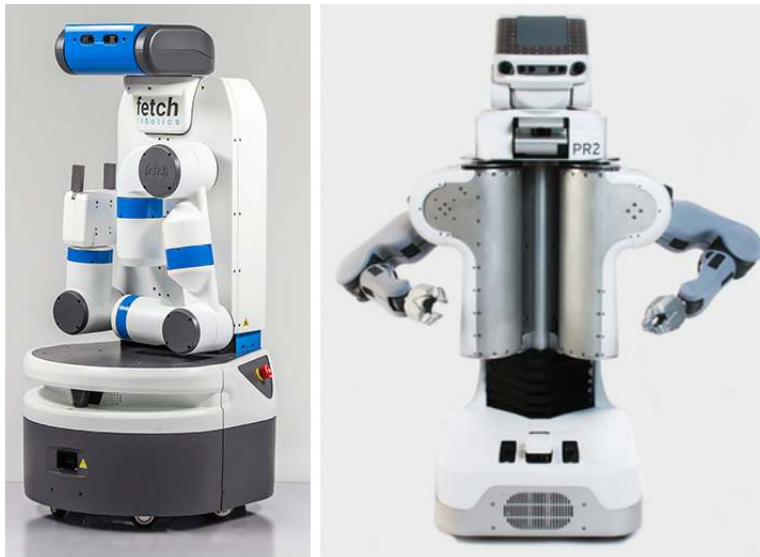
Figura 5.2: Fetch (izquierda) y PR2 (derecha), robots de servicio móviles manufacturados por las empresas Fetch Robotics y Willow Garage, respectivamente.
