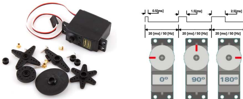
Figura 5.9: Servomotor analógico controlado por una señal de entrada de tipo PWM y cuyo eje es capaz de tomar posiciones dentro del intervalo [0^\circ, 180^\circ] .
